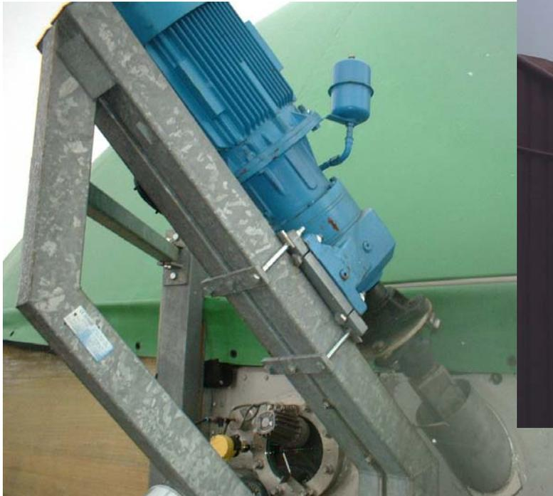
Gegen Schwingungen gesichertes Rührwerk
