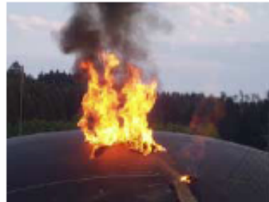
Bild 10 + 11: 6. Brandversuch ein brennender benzinetränkter Lappen wird auf den Folliengasspeicher geworfen
