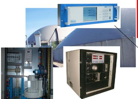
Kontinuierliche Rohgasanalyse: CH<sub>4</sub>: Motorsteuerung und Ex - Schutz
