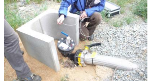
Abb.2 Messung am Brunnenkopf [DAS-IB GmbH, 2009]
