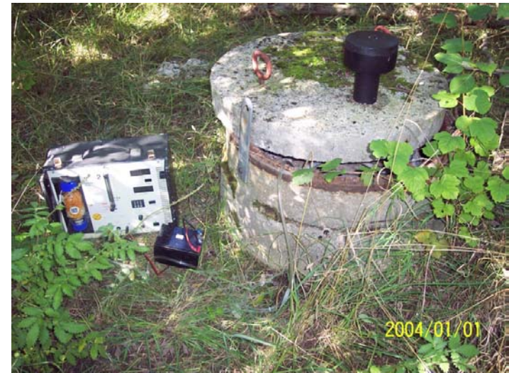
Abb. 16 Gaspegelmessung einer Altablagerung [DAS-IB GmbH, 2010]
