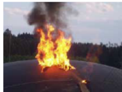
Bild 10 + 11: 6. Brandversuch ein brennender benzingertränkter Lappen wird auf den Foliengasspeicher geworfen
