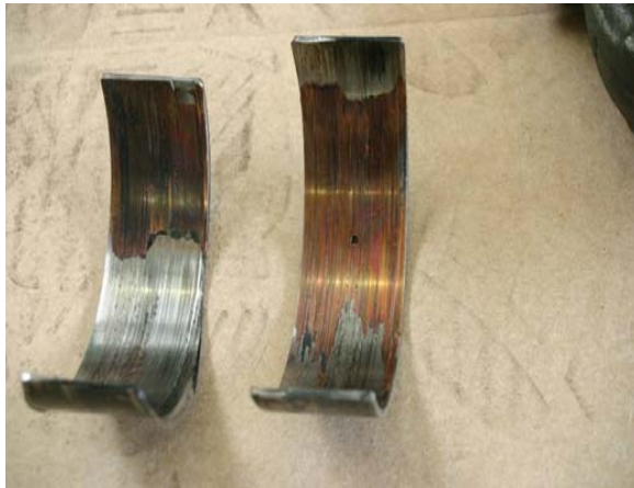
Abb. 1: Buntmetallangriff & abrasiver Verschleiß Lagerschalen
