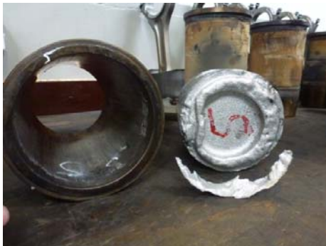
Abb. 3: thermisch belasteter Kolben
